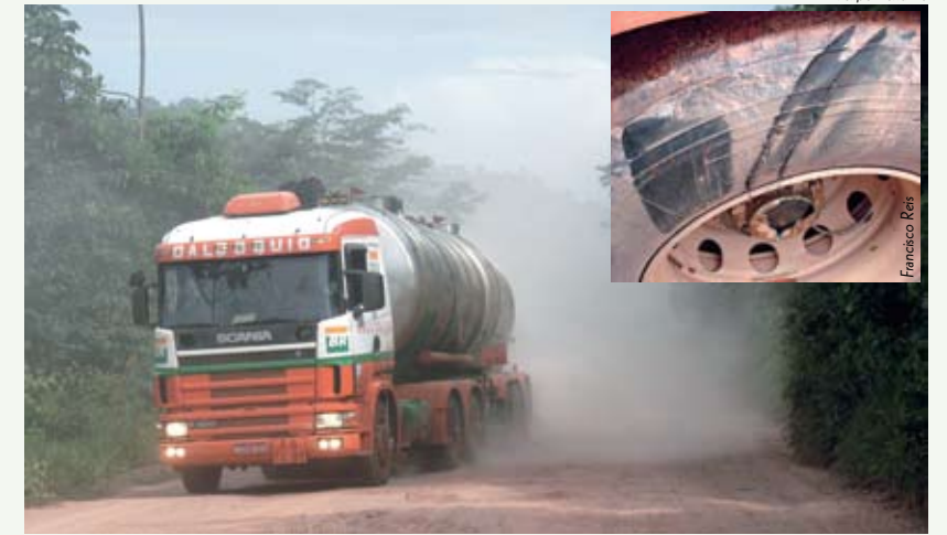
Com a pista seca, a poeira tira a visibilidade e esconde as pedras que podem rasgar pneus e destruir cubos.
